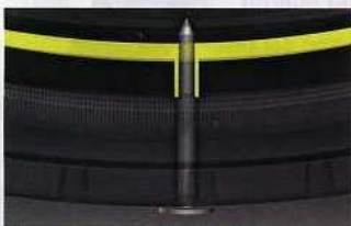
Die DuraSeal-Schicht umschließt eindringende Fremdkörper und hält dicht.
