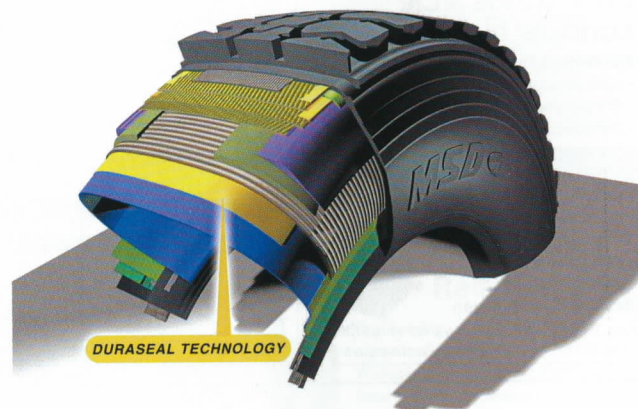
Keine Angst vor Plattfüßen: Duraseal-Reifen von Goodyear enthalten eine gelartige Gummilage, die kleinere Löcher von selbst verschließt.
